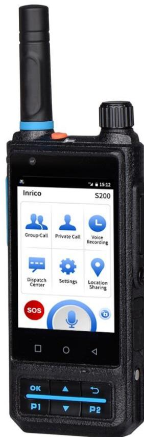
PoC signifie Press-to-talk Over Cellular. Ce n'est pas une technologie radio bidirectionnelle à proprement dit, mais se comporte très bien comme tel. PoC est la technique qui consiste à utiliser le réseau de téléphonie mobile pour effectuer des appels se comportant comme une radio bidirectionnelle classique avec accès instantané et appels un à plusieurs, mais bénéficiant de la couverture mondiale des réseaux de téléphonie cellulaire, GSM, 3G, 4G etc
